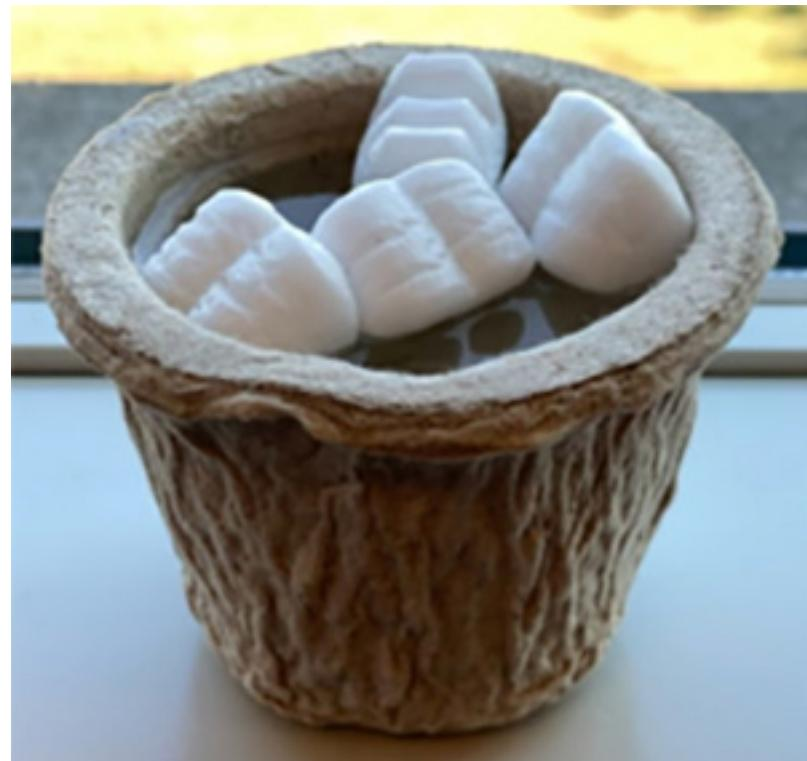
Figur 1: Den allerførste "prototype" af en fiberkasse – en vandtæt, termoisolerende letvægtskop, der er blevet vådstøbt af en pulp bestående af ca. 70% græsfibre.
