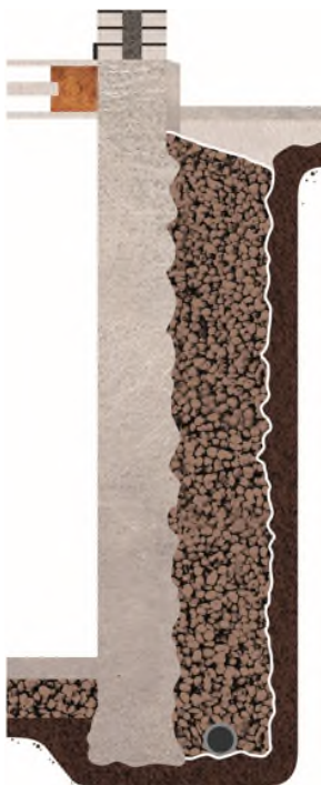
Figur 3.9. Letklinker kan anvendes både som filtermateriale og som isoleringsmateriale.
