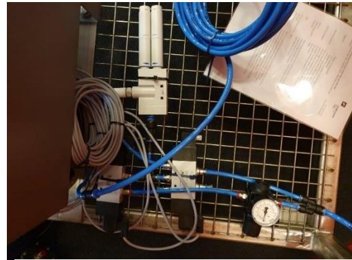
Figur 8: Elektronisk styret pneumatisk system til griberen
