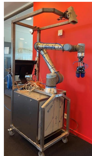
Figur 9: platform med kamera, griber, robotarm og controller
