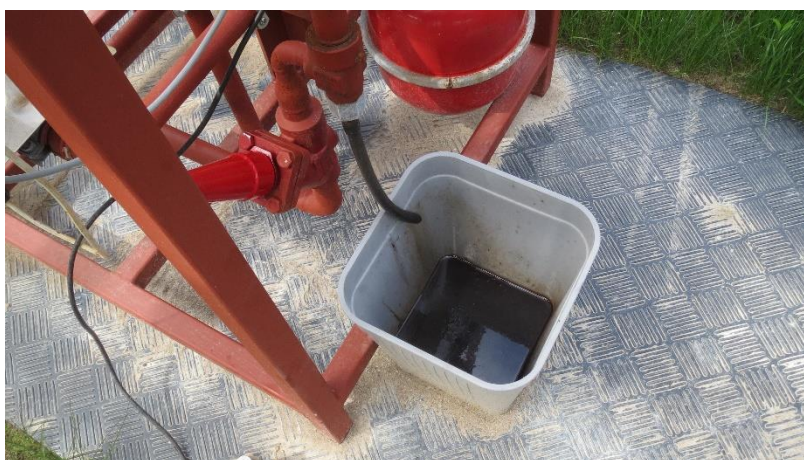
Figur 39: VSO'er - Vand-, Snavs- og Olieopsamlingssystem (2021.06.23)
