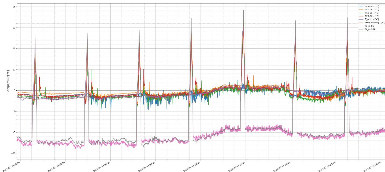
Figur 17: Målinger af tilgangstemperaturer for udeluft under fordampner #16 i Brædstrup
