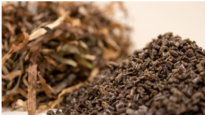
Coastgrass ApS har specialiseret sig i at anvende ålegræs i materialer til erstatning af plast i produkter. Bagved i billedet ses ålegræs. Foran, en biokomposit med indhold af ålegræs.
