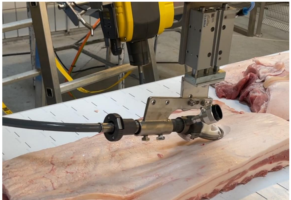
Figur 1: Værktøjet til fjernelse af sværrest
