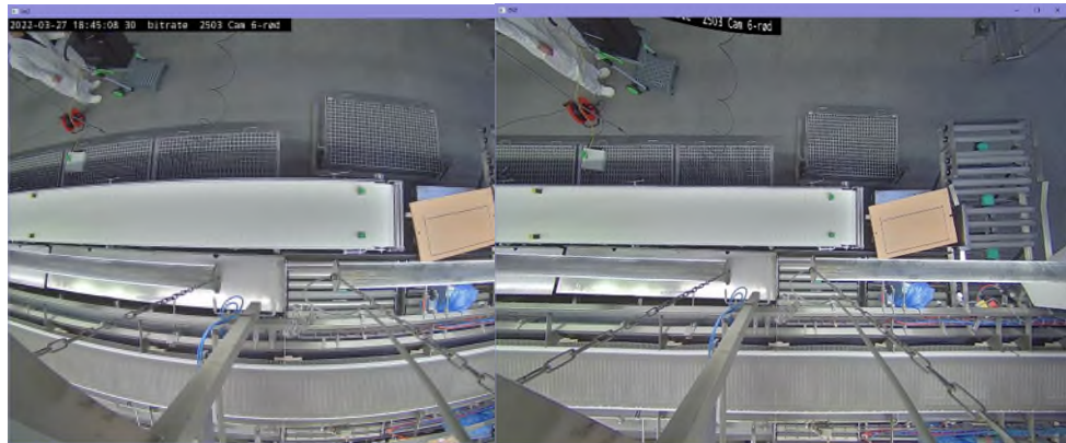
Billede 3: Før (venstre) og efter (højre) efter korrigering af barrel distortion
