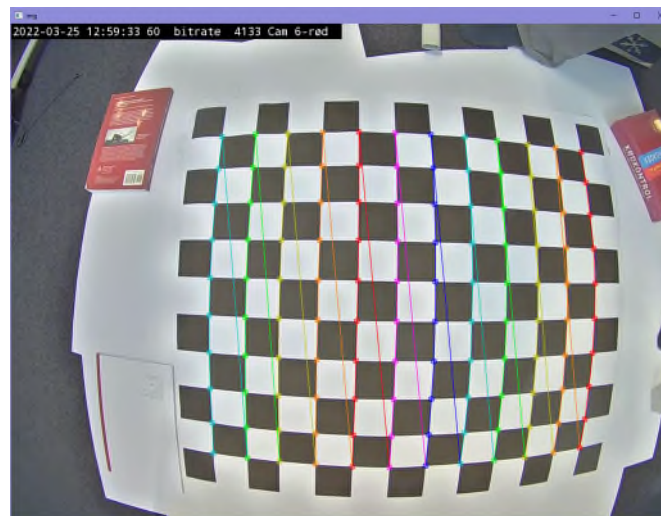
Billede 2: Referencebillede til kalibrering af linse mod barrel distortion.
