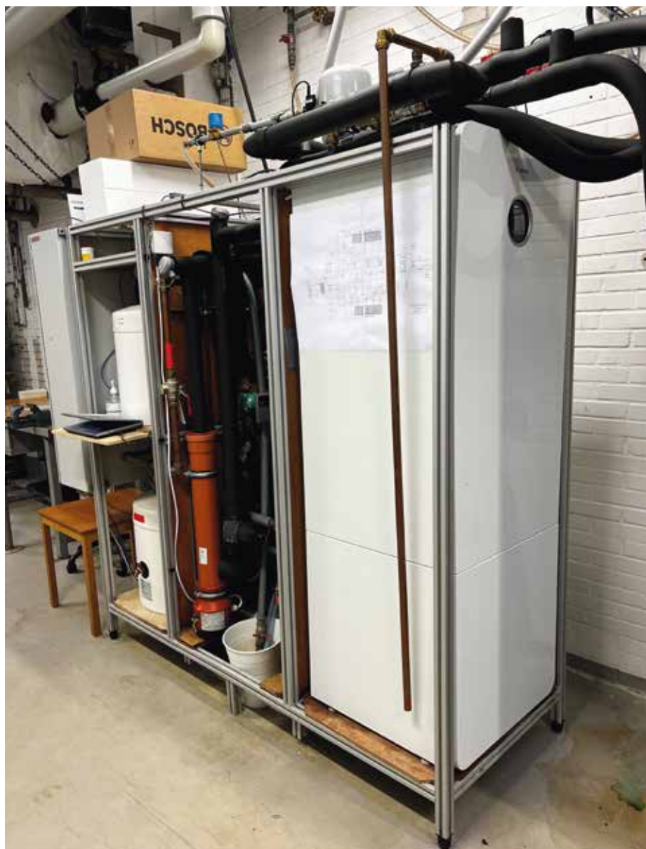
Opsys teststand på Teknologisk Institut. Første fag fra venstre indeholder varme- og kølebuffer. Midterste fag er gulvvarme-manifold og fire vekslere, som hver repræsenterer en gulvvarme-streng. Sidste fag er jordvarmepumpen (Bosch) og jordvarme buffertank til sidst.
