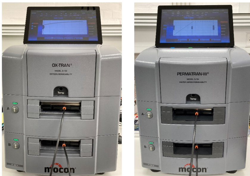
Figur 2. Plast og Emballage har udstyr til måling af OTR (venstre) og WVTR (højre).
