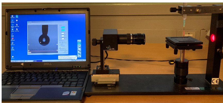
Figur 4. Opstilling til måling af kontaktvinkel.
