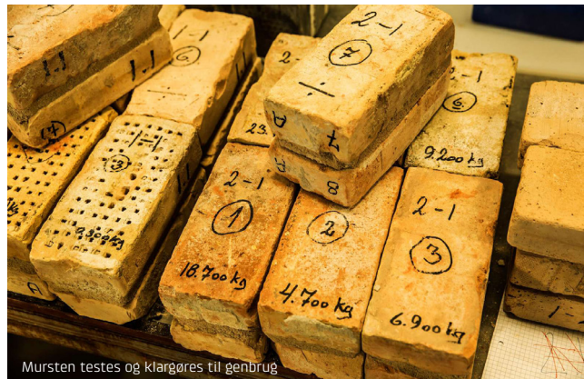
Mursten testes og klargøres til genbrug
