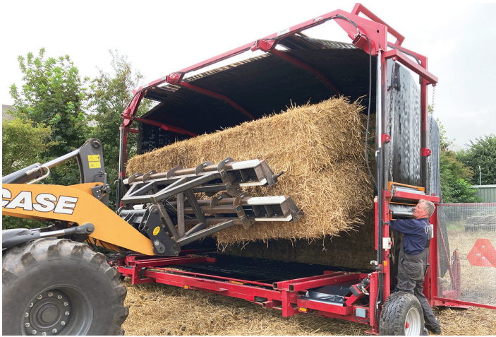
Indpakning af baller med våd halm med Wrap8-systemet i forsøgsstak med 216 baller 28/8 2022. Greben klemmer ballerne sideværts sammen for at minimere luftrummet mellem ballerne.
