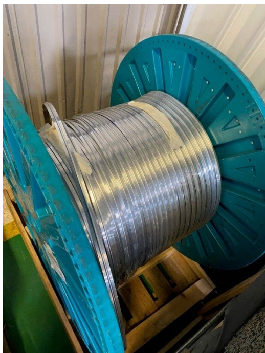
Rulle med 5 mm flangerør.
