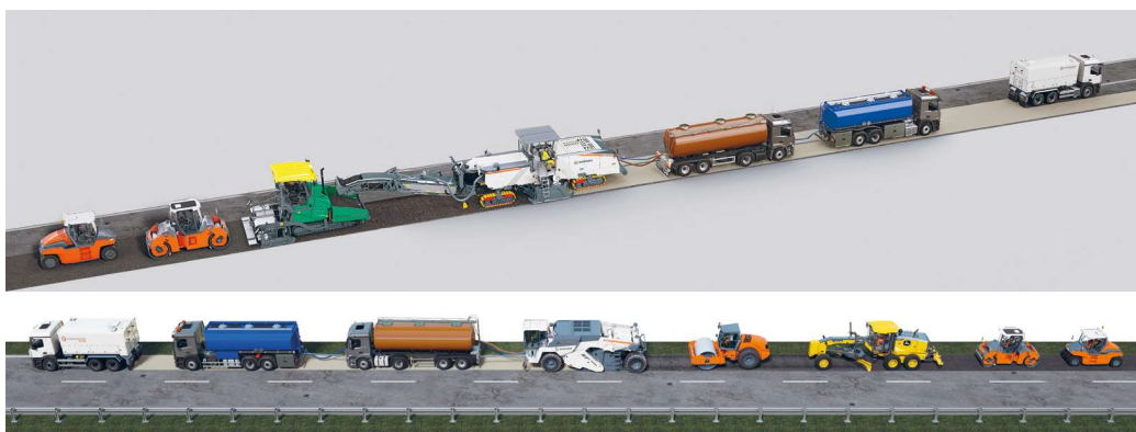
Øverst: Princip for fremstilling af BSM-in situ med CRi-maskine. Nederst: Princip for fremstilling af BSM-in situ med WR-maskine Kilde: Wirtgen
