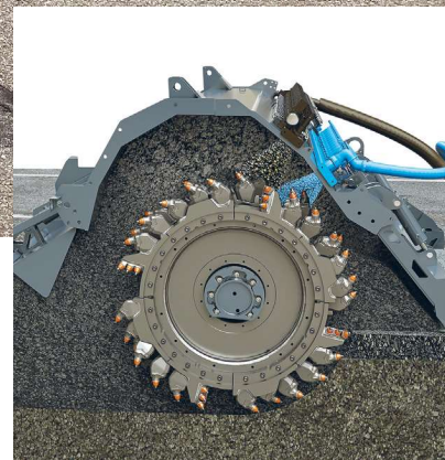
Principskitse, fremstilling af BSM-in situ direkte i fræsekammeret. Kilde: Wirtgen.
