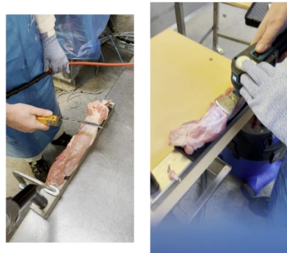
Figur 2 Multicutter og oscillerende kniv til Automatisk mørbradpudsning
