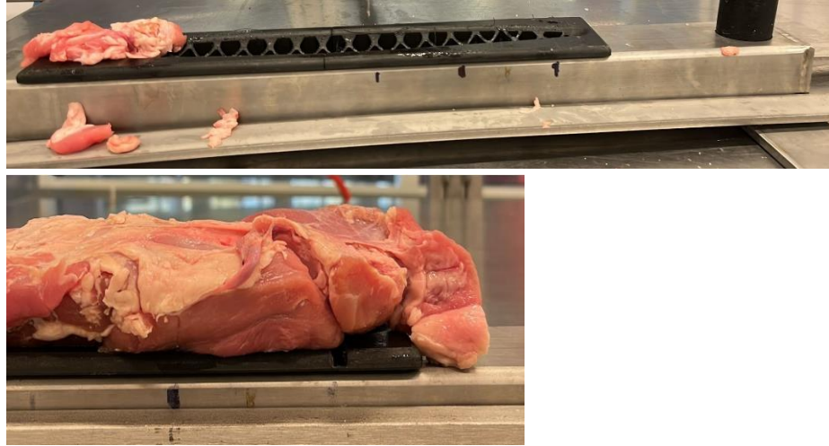
Figur 3 Sugeanordning til automatisk mørbradpudsning.
