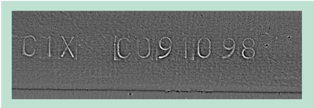
FIGUR 6. Relativ dybde af præget ID i forhold til pladens overflade. Billedet er genereret via fotometrisk stereo ud fra et billedsæt af 6 billeder.
