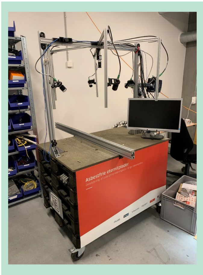
FIGUR 5. Laboratorieopsætning for afprøvning af fotometrisk stereo. 6 lyskilder placeret i forskellige positioner belyser alle det samme område på ca. 30x30 cm. Kamera er placeret direkte over dette område med billedfeltet rettet mod området.
