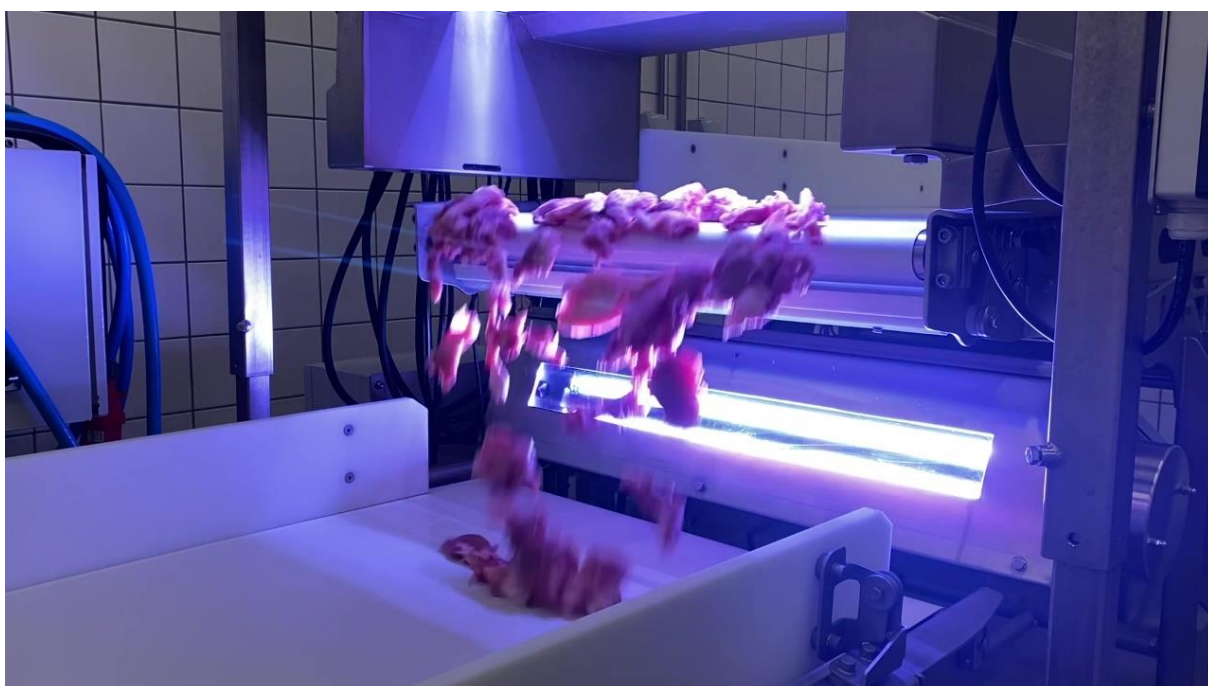
Figur 4. Eksempel på vandfaldseffekten, hvor undersiden af produktet også måles i det frie fald fra det ene bånd til det andet.
