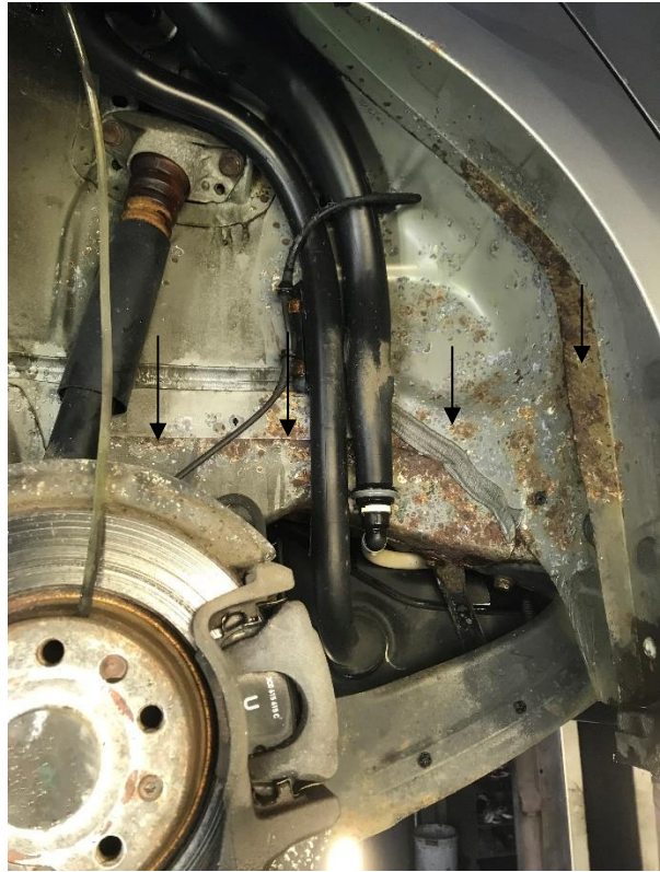
Behandling af tværvanger vanger og traverser samt hulrum i bundsektionen.
