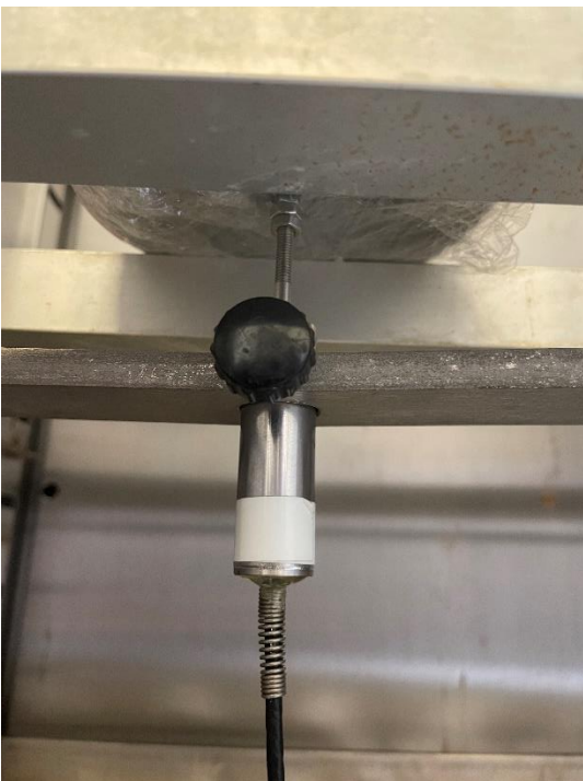
Billede 4: Detalje af samling mellem transducer og cylinder
