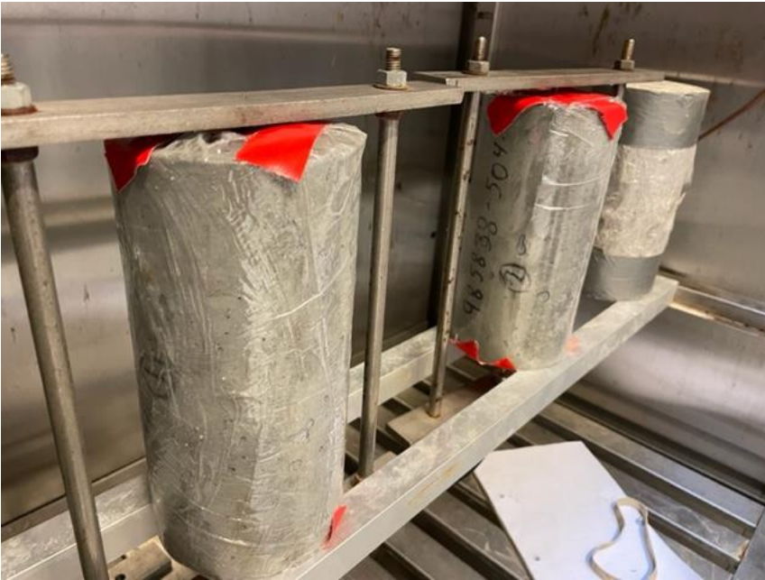
Billede 3: Cylindre monterede i rammer i det temperaturstyrede klimskab.
