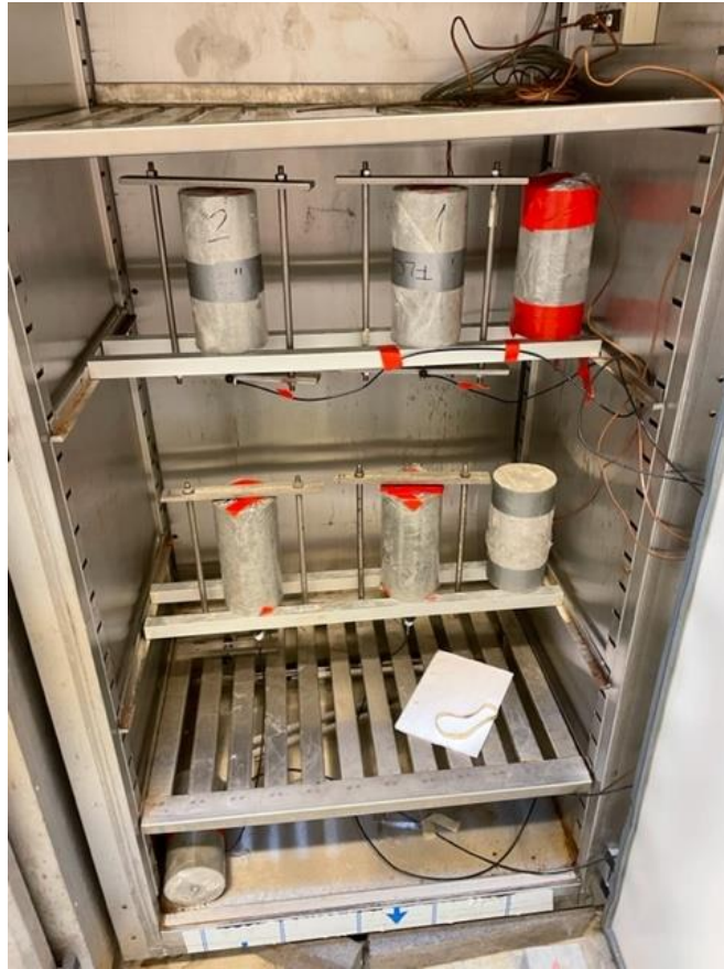
Billede 5: Eksempel på forsøgsopstilling. Temperaturer logges i cylinderen til højre på hver række, og deformationerne registreres på de to cylindre til venstre.
