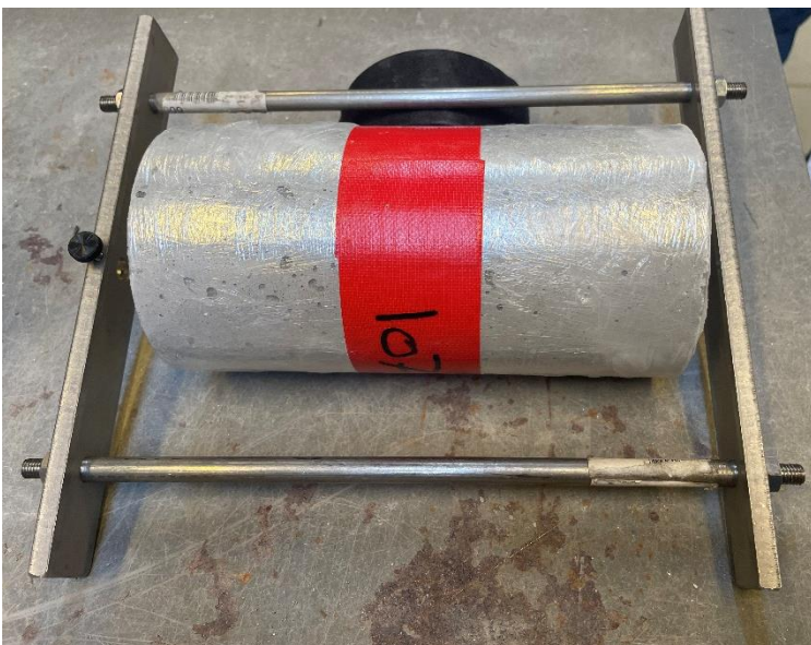
Billede 2: Ramme og cylinder klar til samling. Hul til montage af deformationsm ler ses til venstre i billedet.
