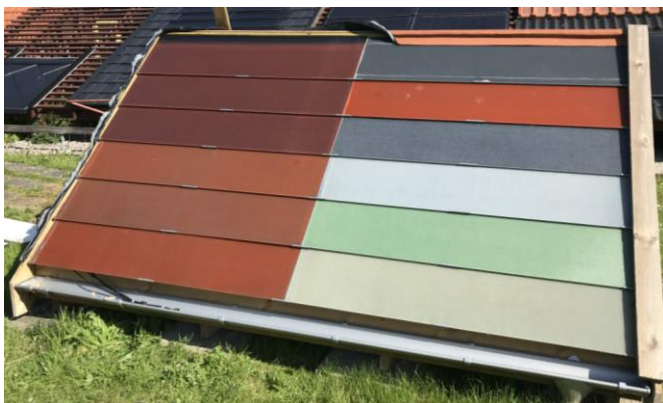
Figur 1 Prøvefelt med forskellige farver moduler fra Dansk Solenergi opstillet på Teknologisk Institut.
