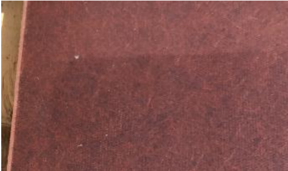
Figur 2: Et hjørne af modulene, hvor cellen kan anes som en mørk skygge, og glassets struktur kan ses som regelmæssige prikker. De uregelmæssige tråde stammer fra materialet mellem glasset og cellen.
