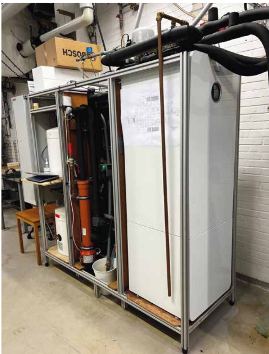
Opsys teststand på Teknologisk Institut. Første fag fra venstre indeholder varme- og kølebuffer. Midterste fag er gulvvarme-manifold og fire vekslere, som hver repræsenterer en gulvvarme-streng. Sidste fag er jordvarmepumpen (Bosch) og jordvarme buffertank til sidst.
