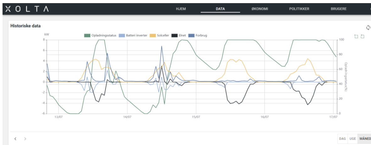
Figur 35 Eksempel på driftsmønster trukket fra Xoltas brugerapp. Bemærk, at der på de gode soldage lades på batteriet, samtidig med at der er eksport af el. Dette skyldes begrænsningen i den effekt, der kan lades med.
