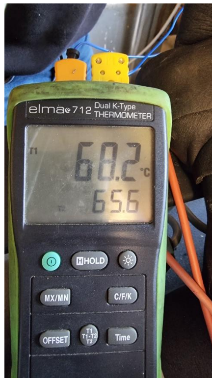
Figur 3. Måling af temperatur på drivvarmen.
