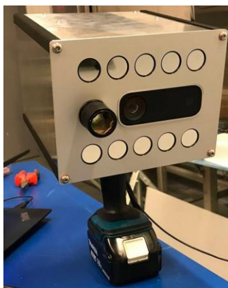
Figur 3. Den samlede prototypeenhed med 10 UV-lamper samt UV- og Kinect-kamera.
