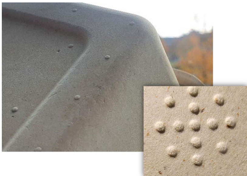
Figur 2: Overfladen af en cellulosebakke støbt af den udviklede pulp med Curran®.
