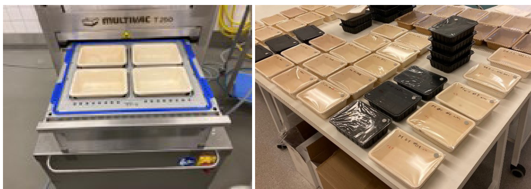
Figur 3: Cellulose- og PET-bakker forseglet i en standard MAP-bakkeforsegler.
