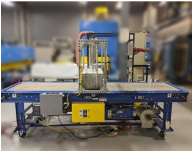
Figur 6: Ultralydsassisteret tørresystem Spectra HE™ Ultra (Test Stand hos Heat Technologies, Inc.)
