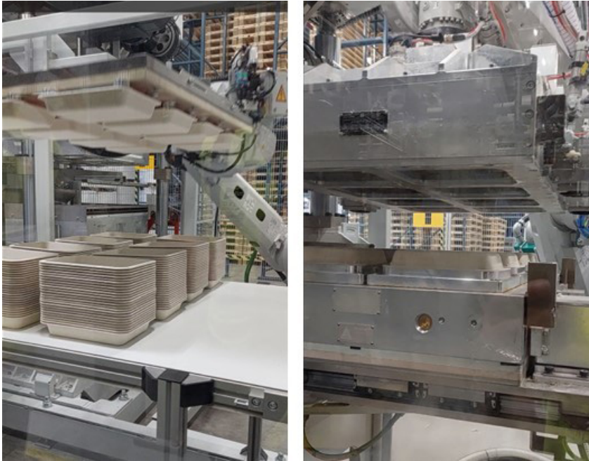
Figur 4: Industriel fremstilling af cellulosebakker i NATUREFORMER KFT 90 støbe-linje.
