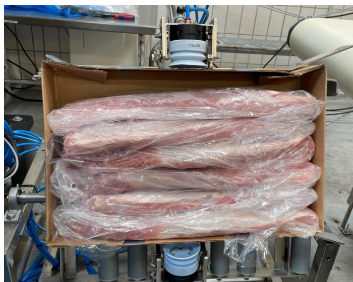
Figur 13: udposning i bunden af kassen med folie
