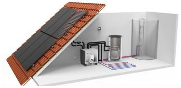
Figure 6. Complete PVT energy system from Nærvarmeværket.
