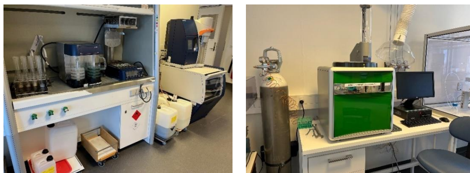
Figur 1. Venstre: Kjeldahlinstrument med tilhørende destruktionsudstyr, reagenser og affaldsbeholdere. Højre: Dumasinstrument med tilhørende gasflaske.
