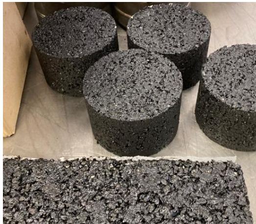
Fig. 7.3.4: Eksempel på asfaltplade og Marshall-indstampede prøvelegemer til test.
