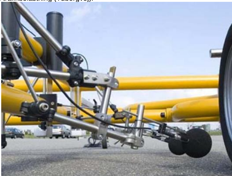
Fig. 13.1.1: DeciBella CPX-trailer med mikrofoner nær dækkene (foto: VD).
