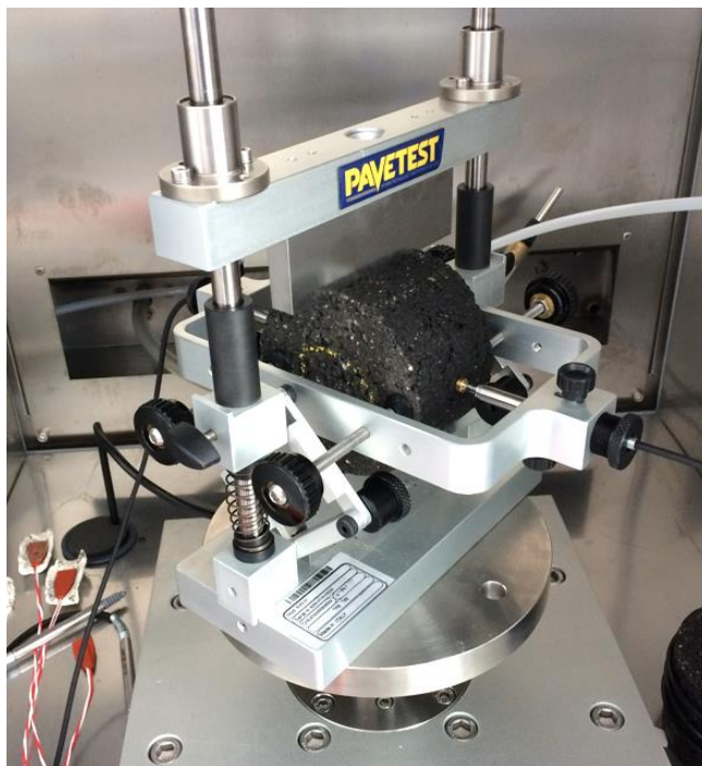
Fig. 13.4.1: Bestemmelse af asfaltmaterialers stivhedsmodul. Der påføres små slagvise belastningspulser via belastningsbjælken (spaltetræk-opstilling), hvor de tilhørende udbøjninger i vandret plan, vinkelret på belastningen, måles hvorefter stivheden kan beregnes.
