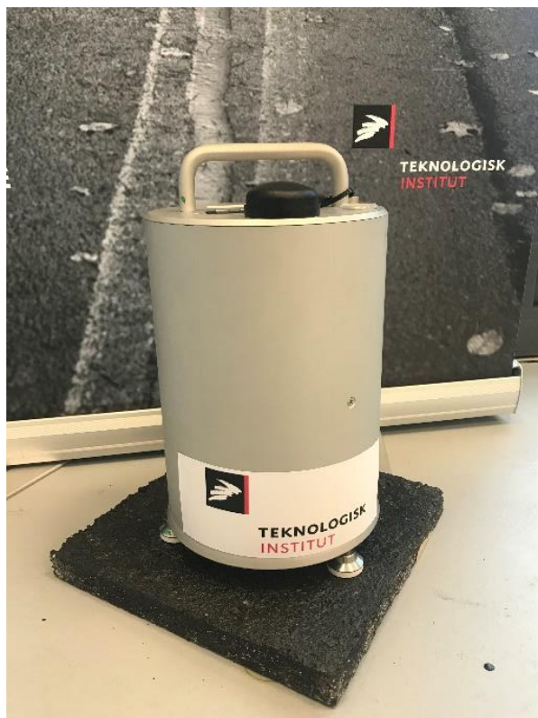
Fig. 5.7.2: Avanceret, laserbaseret udstyr til teksturmåling af asfaltplader i laboratoriet. [1]
