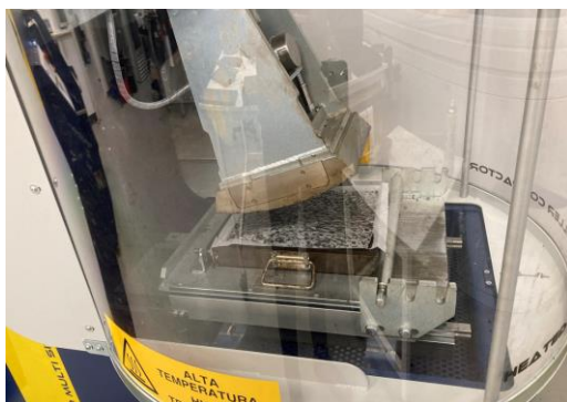
Fig. 7.3.1: Indtromling af asfaltplader i laboratoriet. Fig. 7.3.2: Eksempler på asfaltplader
