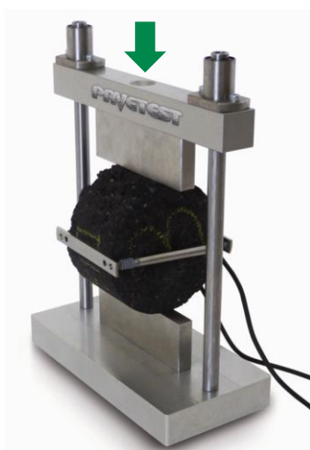
Fig. 13.6.1: Testopstilling for udmattelsestest jf. DS/EN 12697-24, IT-CY
