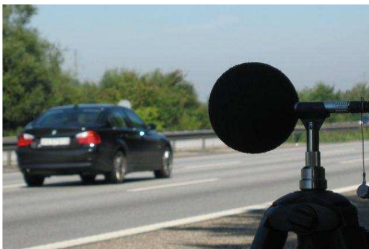
Fig. 5.6.1: Princip for vejside-støjmåling med mikrofonopstilling (SPB-metoden) [9]
