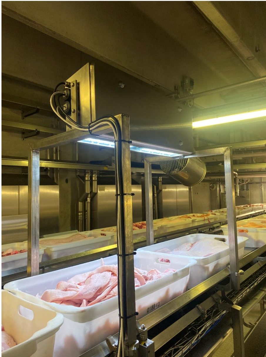
Figur 5. Den endelige visionopstilling monteret hos værtsslagteriet over transportbånd med kasser, der alle måles af visionudstyret, når de passerer forbi.
