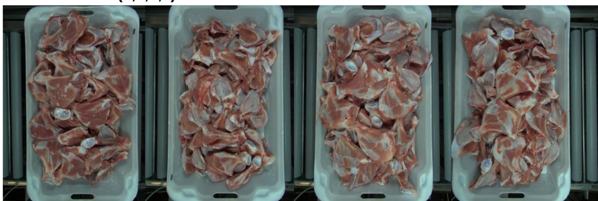
Figur 3. Billedeksempler fra visionudstyret, der viser vurderingen af skærekvalitet ift. 4-trinsskala-klassificering af produkter i kasser ifm. skæreforsøg foretaget på stikprøver i produktionen hos et dansk slagteri.
