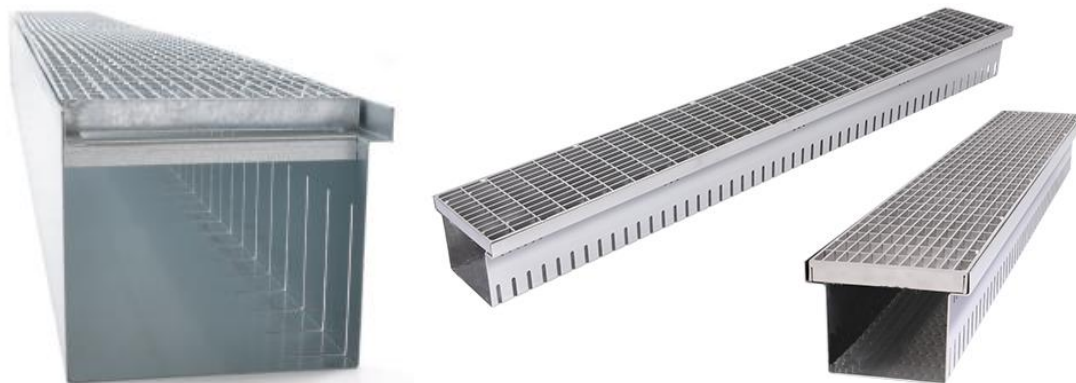
Figur 7.1. Sokkelrende/facaderende til taghave. Her skal den tætte del af renden vende ind mod soklen/facaden.
