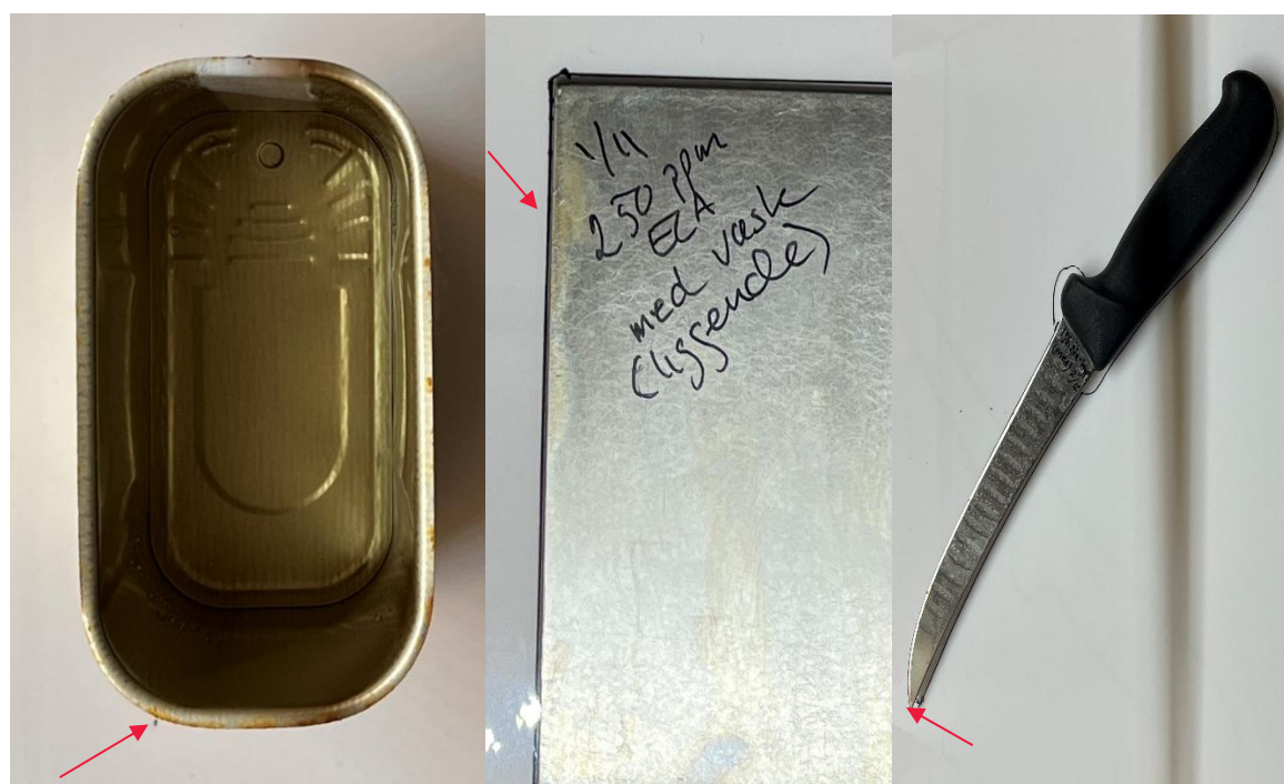
Figur 13. Korrosion på forskellige ståloverflader. a: konservesdåse (1% Na-hyp, uden vask, dag 4), b: stålplade AISI 304 (250 ppm ECA, med vask, dag 24), c: kniv (1% Na-hyp, med vask, dag 56).
