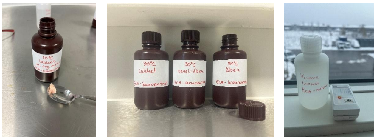
Figur 20a. Eksempler på beholdere med koncentreret ECA-vand brugt i stabilitetsforsøget: tilsat organisk materiale (tv), lukket/semiåben/åben (midtfor) og gennemsigtig beholder (th).
