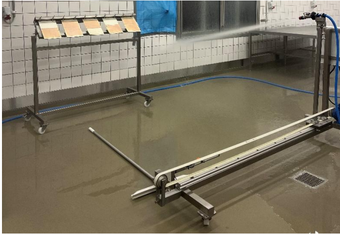
Figur 4. Forsøgssetup for test af desinfektionseffekt. De tilsmudsede overflader blev fastspændt på stativet. Stativet blev placeret 1 meter fra dysehovedet. 1 stativ med 5 plader repræsenterer én test. På billedet er der udtaget svaberprøver til bestemmelse af startkimal, før overfladerne blev rengjort og desinficeret.
