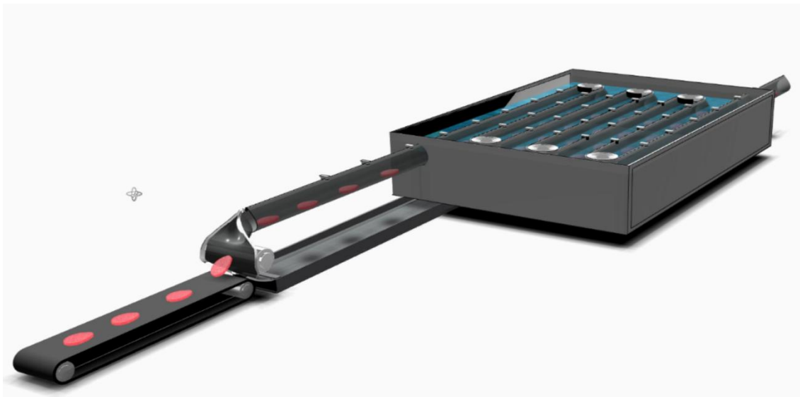
Figur 6. Skitse af driftsanlæg med afleveringsbånd til de kølede produkter.
