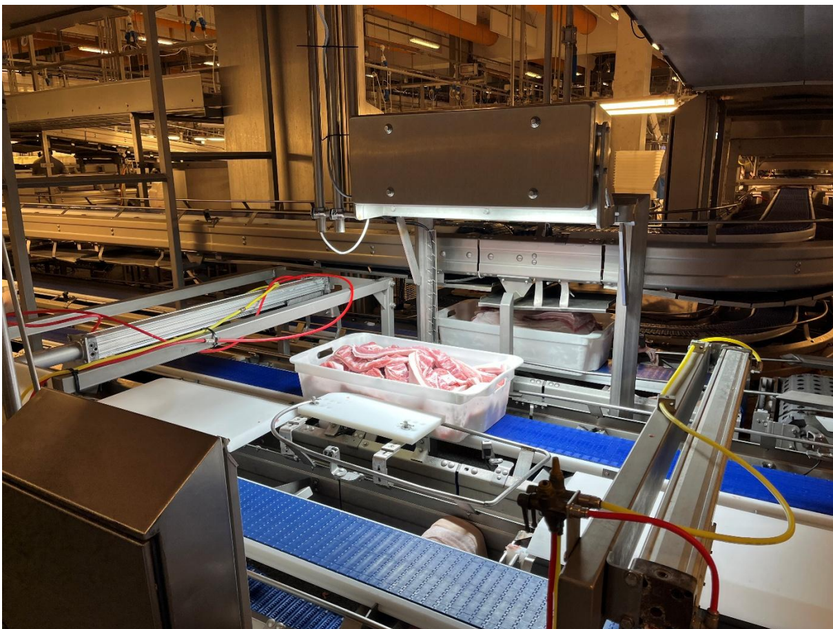
Figur 2. Ovenstående viser visionudstyret installeret over et af de centrale kasetransportbånd hos værtsslagteriet. Kameraet dækker hele kassens overflade og optager kontinuert billeddata af produkterne, der passerer fra udbeningslinjerne til udvejstationerne.
