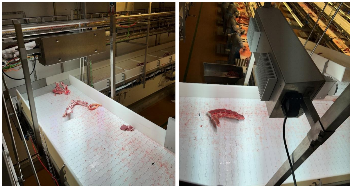
Figur 1. Ovenstående viser billeder fra opsætningen af visionudstyret monteret over benbåndet, der modtager knogler fra 2 udbeningslinjer i skærestuen til udbening af hhv. for- og bagfjerding. Kameraet kan se hele bredden af transportbåndet og et udsnit af båndet i længderetningen, hvorfor kameraet kontinuert tager billeder for at kunne foretage en dataopsamling af alle kogler, der passerer forbi.
