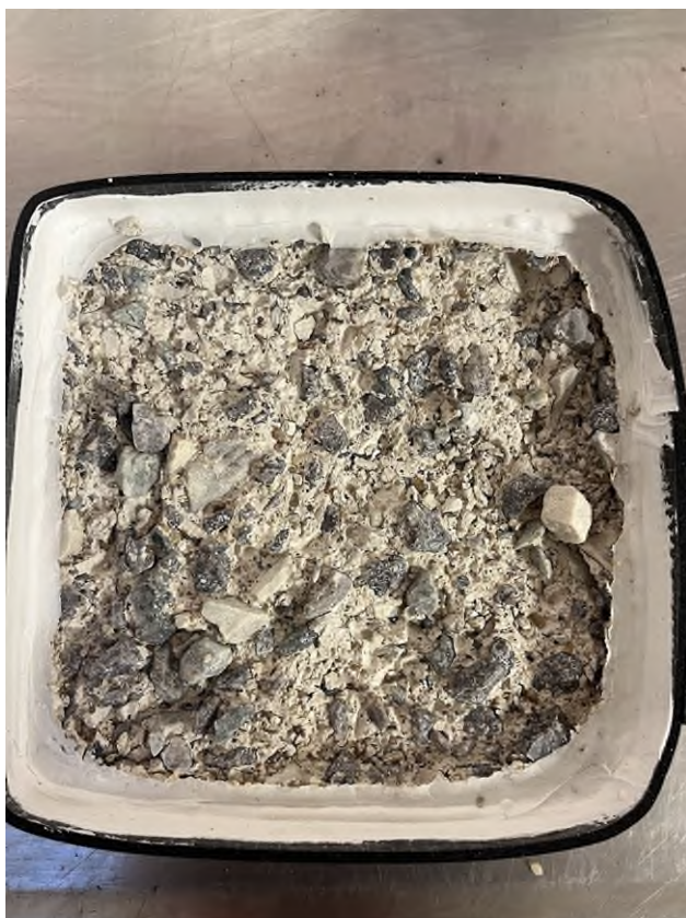
Billede af AA1-A beton efter frostbestandighed
