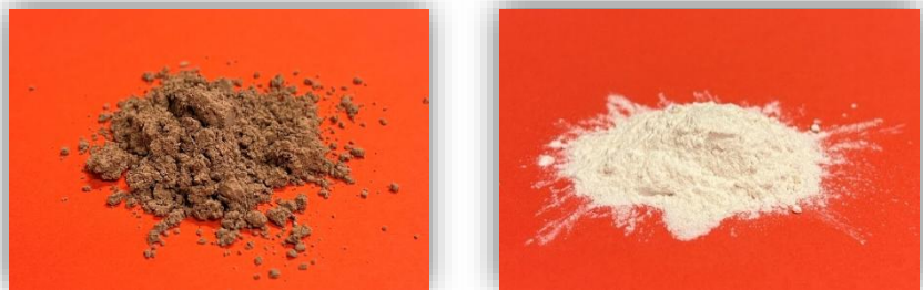
Figur 1. Venstre: Proteinhydrolysat (griselunger) fremstillet ved alkalisk ekstrahering. Højre: Proteinhydrolysat (grisehæmoglobin) fremstillet ved enzymatisk hydrolyse.
