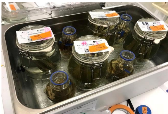
95 °C vandbad med NaOH / 2% eddikesyre
