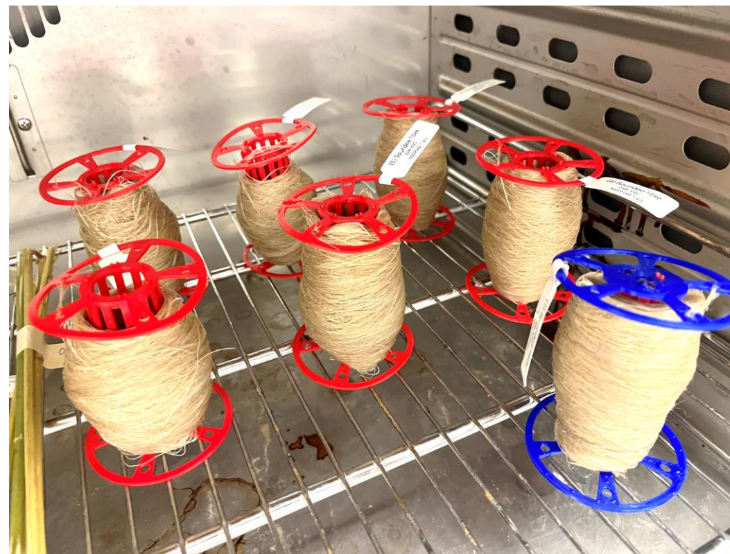
Tørring af enzymbehandlet hampegarn på garnnøgler
