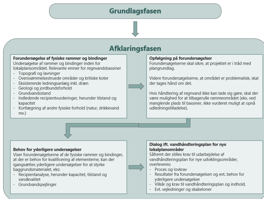
Figur 2.7: Flowdiagram over forhold der bør undersøges i afklaringsfasen.
