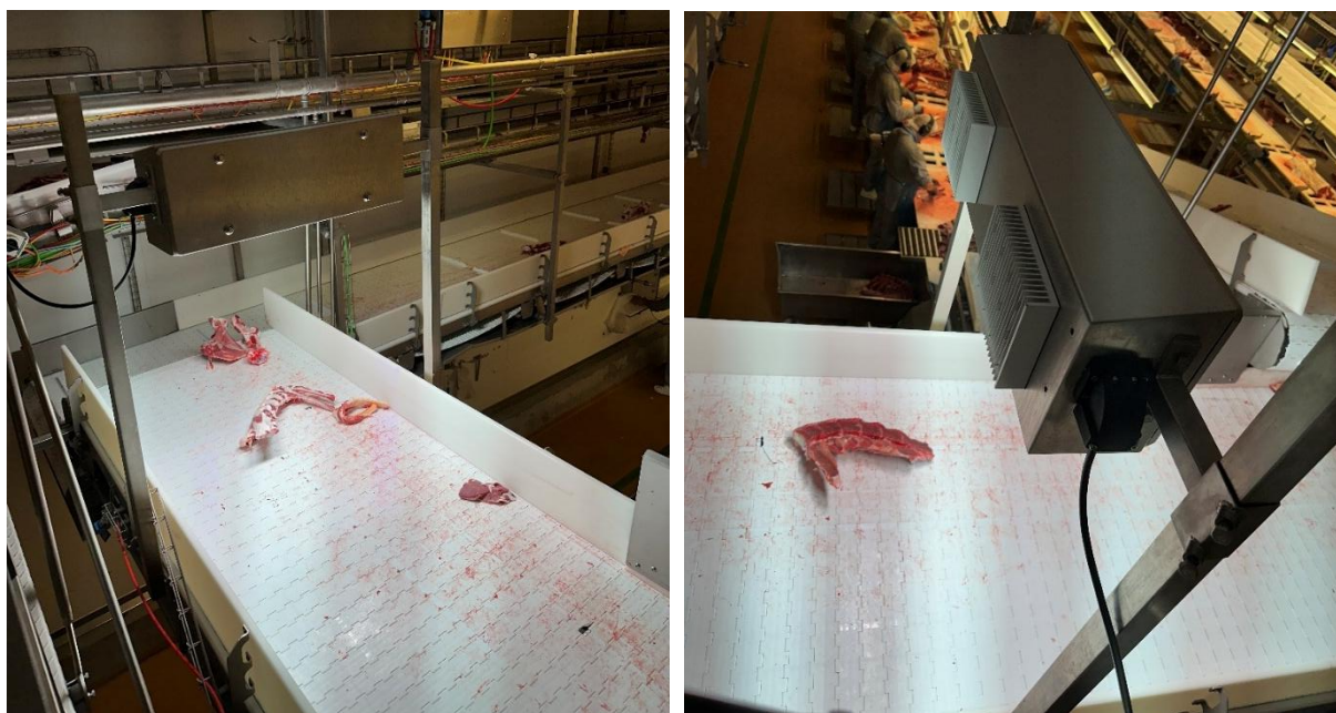
Figur 1. Ovenstående viser billeder fra opsætningen af visionudstyret monteret over benbåndet, der modtager knogler fra 2 udbeningslinjer i skærestuen til udbening af hhv. for- og bagfjerding.
