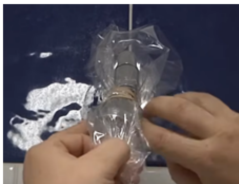
Figur 4: Udtag af vandprøve fra stangbruser. Vandprøven kan udtages direkte fra en stangbruser ved hjælp af en plastpose monteret på brusehovedet.
