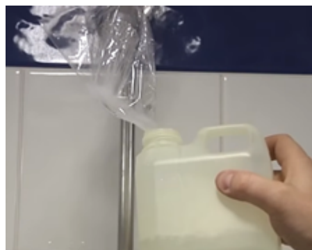
Figur 4: Udtag af vandprøve fra stangbruser. Vandprøven kan udtages direkte fra en stangbruser ved hjælp af en plastpose monteret på brusehovedet.
