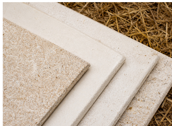
Figur: Fra brugte kaffekopper til akustikplader: Bionedbrydelig plast indgår i udviklingen af nye biobaserede materialer
