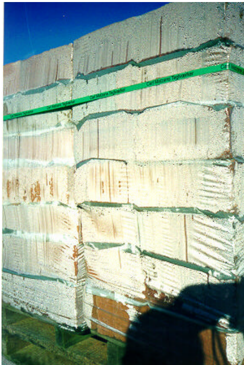
Figur 2. Oplagrede mursten med kondens på emballagefolien.
